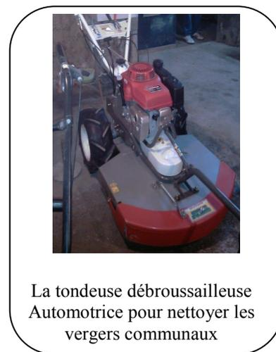
La tondeuse débroussailleuse Automotrice pour nettoyer les vergers communaux
